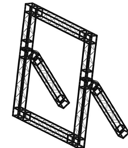
Фермы серии LINE 20 изготавливаются из тонкостенного, грунтованного и окрашенного металла толщиной 1,2 мм
